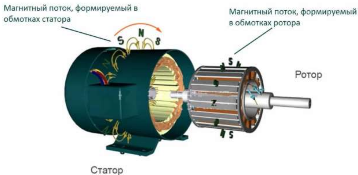
Рис. 2. Принцип действия синхронного электродвигателя
